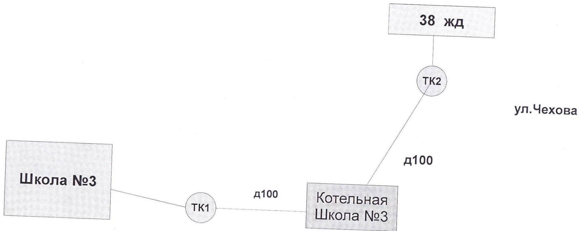
Рис. 13. Существующая зона действия котельной школы № 3 пгт. Тяжинский
